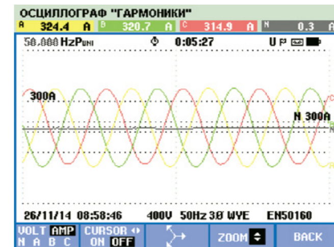
Осциллограмма и гармонический состав входного тока — приемочные испытания ГК «Росатом» и АК «Транснефть» (электродвигатель 7,1 МВт, 10 кВ)
